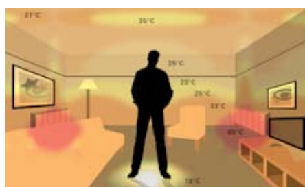
Rozloženie teplôt pri použití tradičného vykurovacieho systému s radiátormi. Veľké rozdiely teplôt v miestnosti (18 – 65°C).
