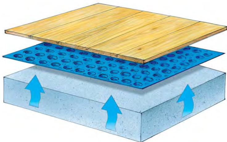
Membrána Platon nabízí rozdílné řešení problémů a předcházení poškozením v konstrukci podlahy.
