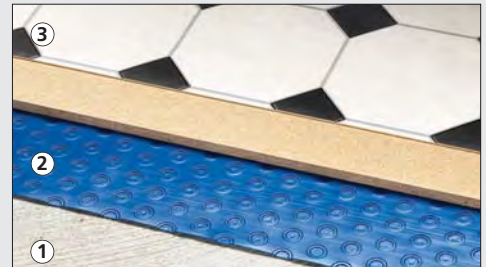
1. Beton 2. Platon Stop 3. OSB desky a konečná povrchová úprava
