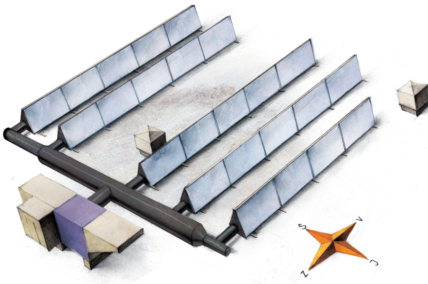
Obrázek 3. - Řady kolektorů systému SolarVenti Industrial® připojené k přívodu vzduchu
