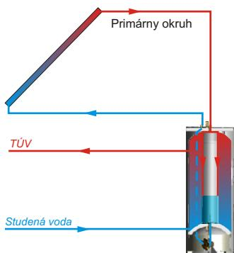
V primárnom okruhu cirkuluje solárna kvapalina, ktorá steká po stenách voľnobežného zásobníka a ohrieva vodu zvnútra.
