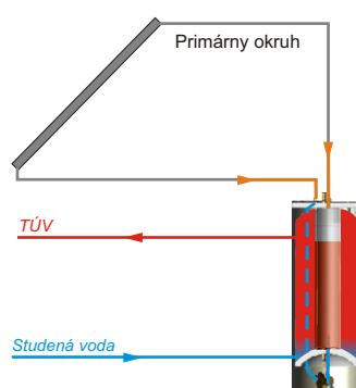
Po nahriatí celej zásoby vody sa systém vypne a solárna kvapalina steká vyspádovaným potrubím do voľnobežného zásobníka, kde je ochránená pred poškodením z prehriatia.
